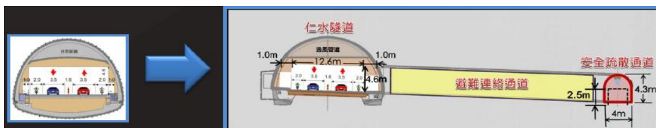
圖 2-12 仁水隧道增設安全疏散通道斷面
