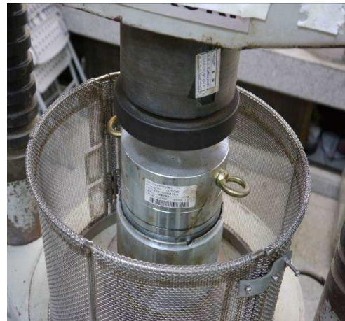
試體安裝及夯壓整備
