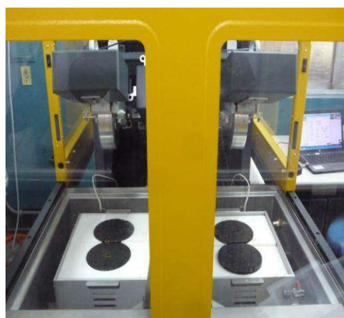
圖 7. 漢堡輪跡車轍試體放置
