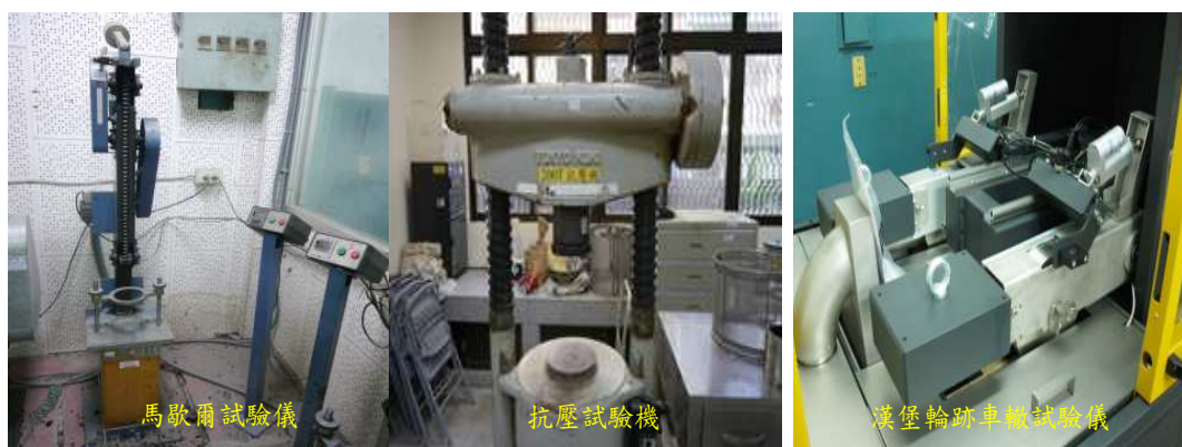
圖 11.瀝青磚製程之儀器設備
