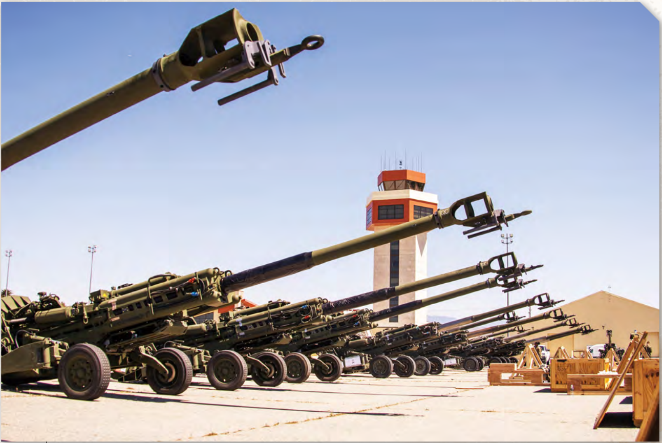
北約提供予烏克蘭的 M777 榴彈砲搭載數位火控系統，有射擊管制、導航、火炮定位定向等功能，並具高遠射程能力。（Photo Credit: U.S. Department of Defense, photo by Austin Fraley, https://www.defense.gov/Multimedia/Photos/igphoto/2002985799 ）
