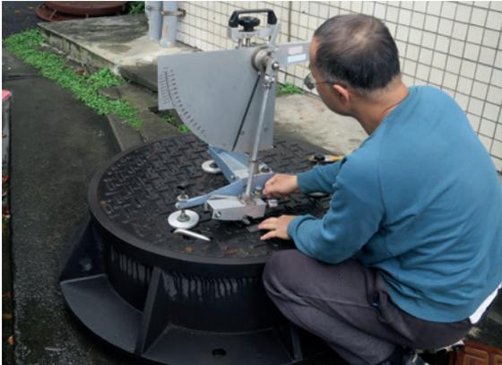
新設人手孔蓋抗滑檢測情形。
