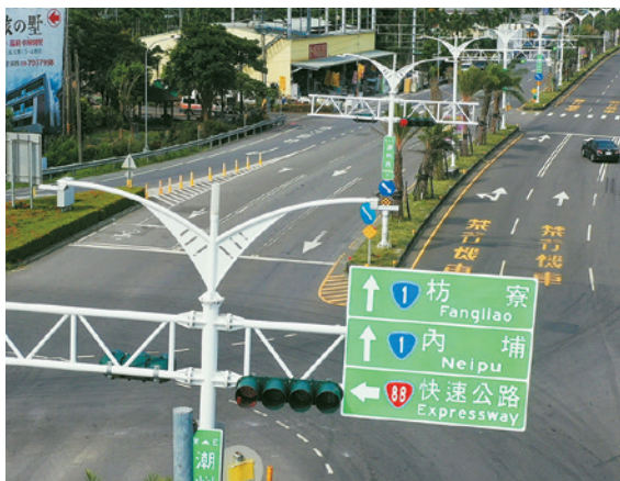
屏 85 及屏 75 線道路景觀改善，包括管線地下化、路燈號誌共桿、標線標誌整合改善等，打造出南島綠廊意象。
