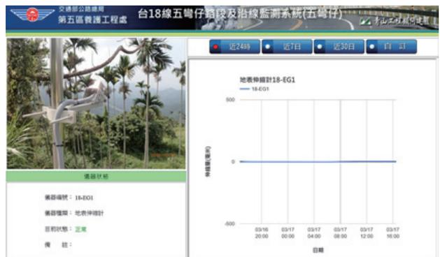
台18線五彎仔路段地表伸縮計自動化監測系統
