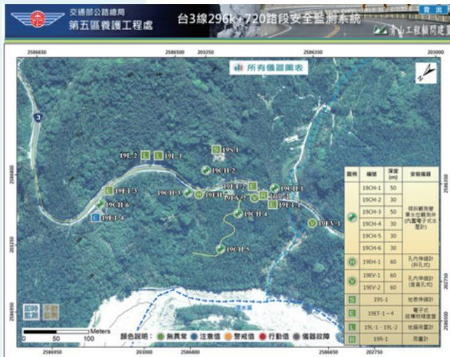
台3線296K+720路段附近監測系統
