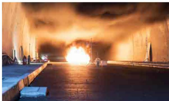
蘇花改蘇澳東澳段—東澳隧道內火災境況模擬測試—火盆測試
