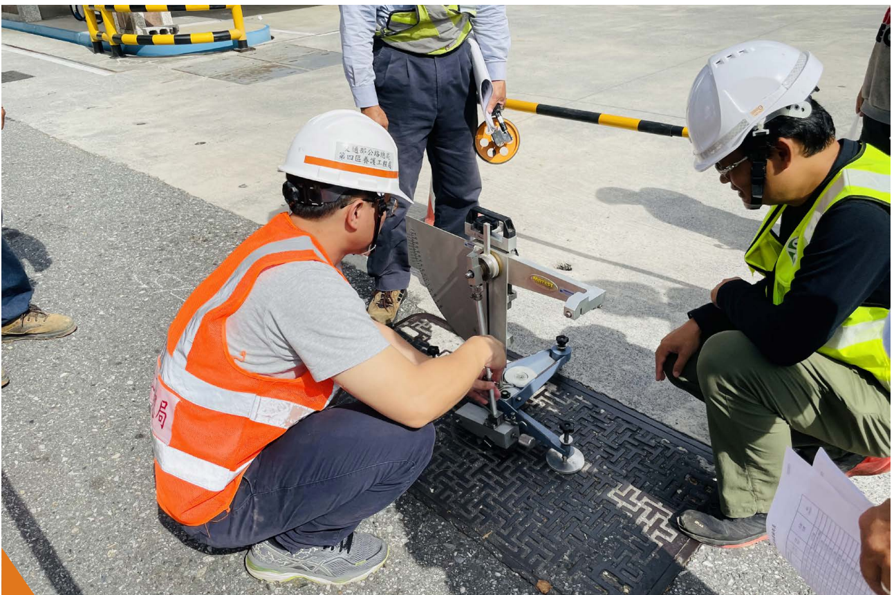
台8線185k+200進行抗滑試驗，手孔摩擦抗滑足夠確保通行安全。
