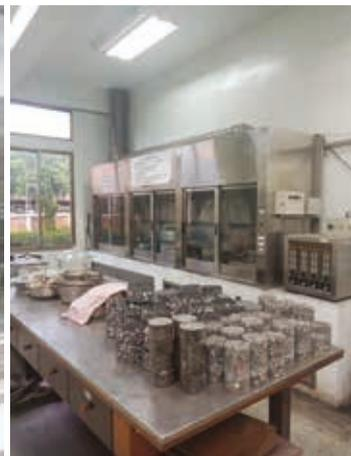
瀝青混凝土鑽心試體
