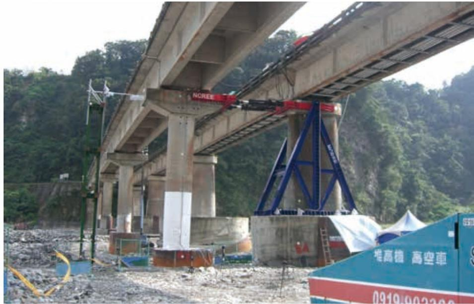
舊牛鬥橋模擬地震力(側向力)測試
