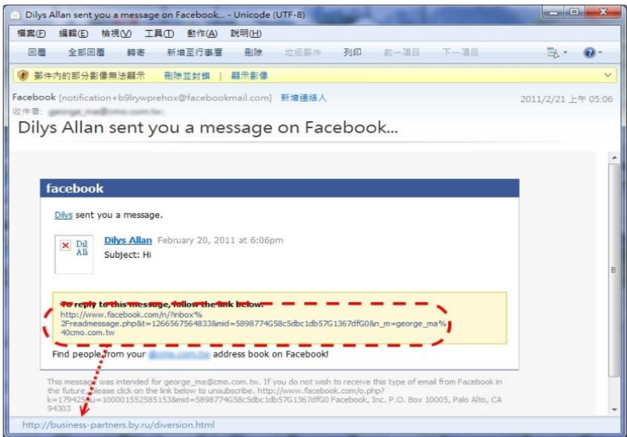
圖 1、順手將滑鼠游標移至該超連結位置上，假造的 facebook 通知信，其中帶有顯示位址與連往位址不一樣的情形。
