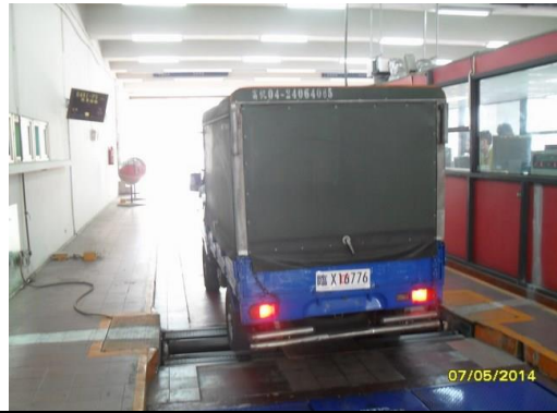
13d.後軸煞車力檢測
