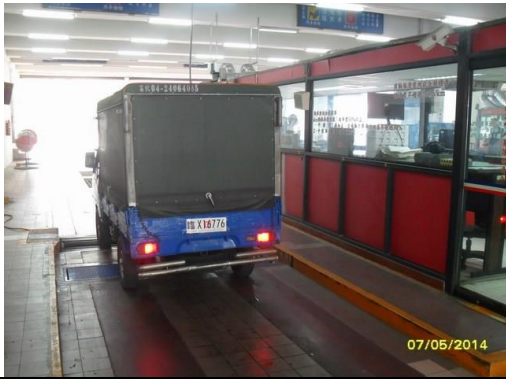
13c.前軸煞車力檢測
