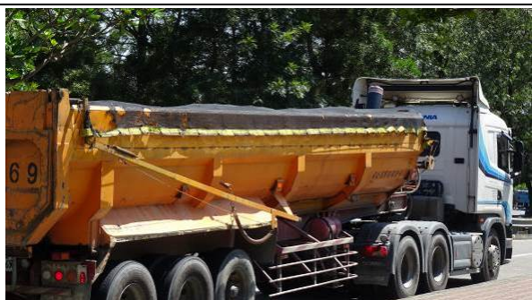
砂石車車斗覆蓋防塵布
