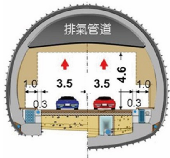
圖 2 隧道段斷面配置
