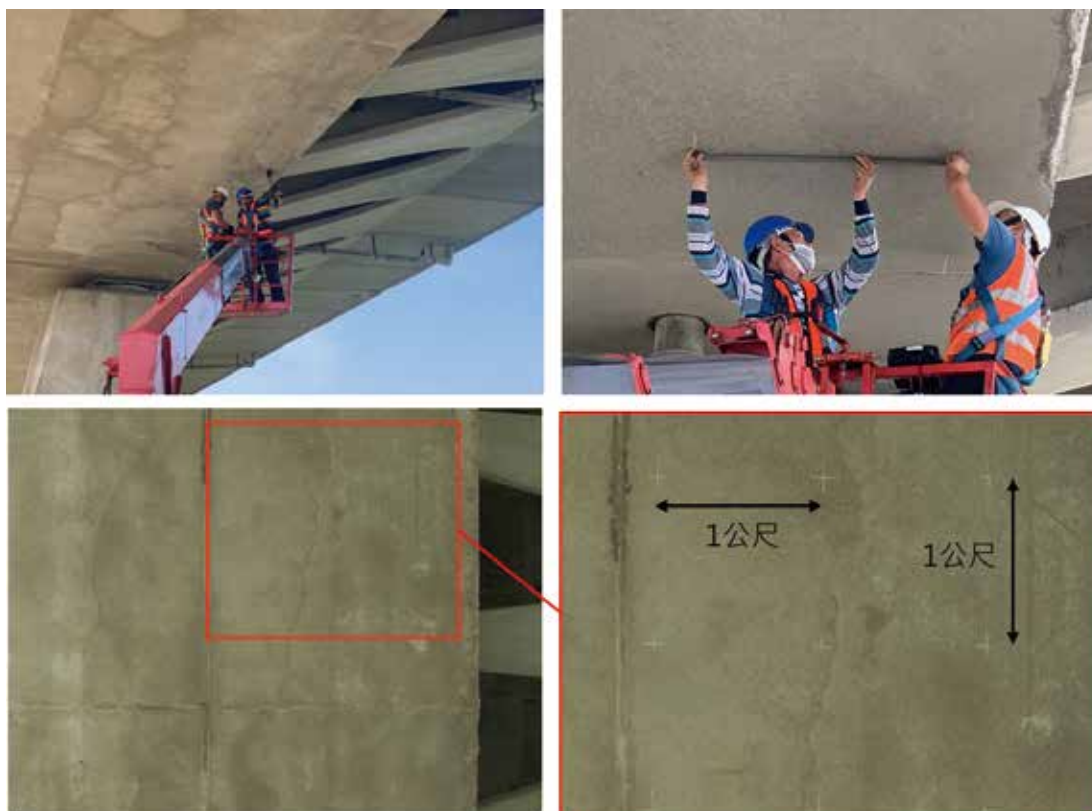
圖 3-2 敲擊回音法工作情形及施測點位標示
