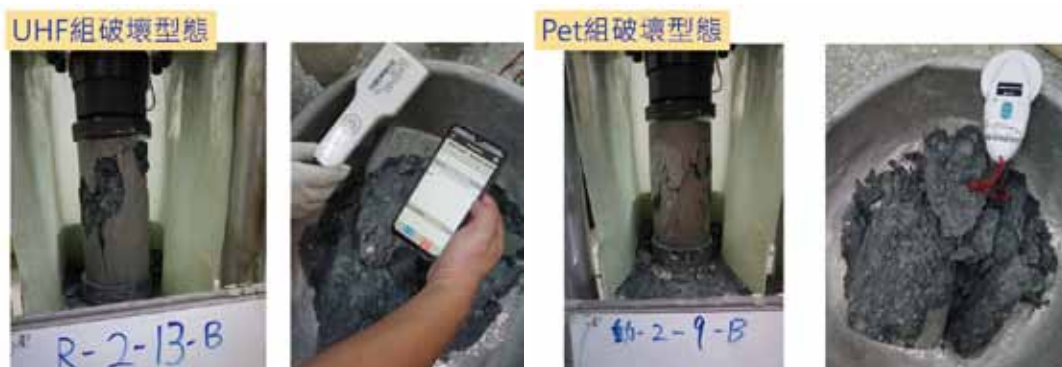
圖 3-8 實驗組圓柱試體破壞型態與 RFID 標籤辨識過程
