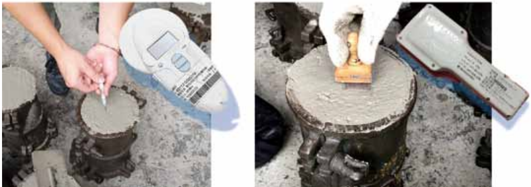
圖 3-4 RFID 標籤之植入與辨識確認
