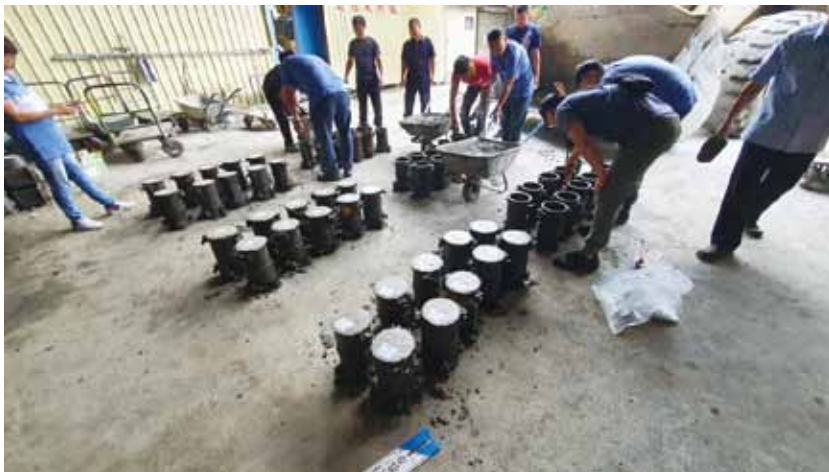
圖 3-2 試體製作現場照片
