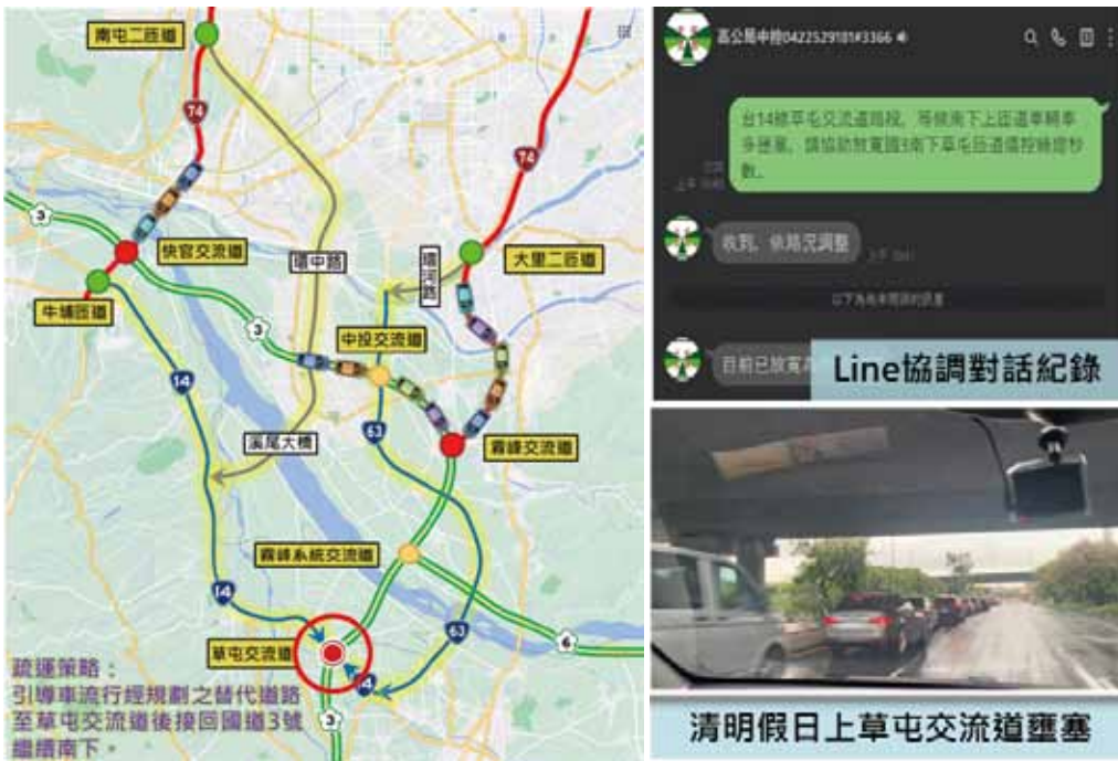
圖 4-11 替代路線皆導回台 14 線 / 國 3 草屯交流道，並協請高公局放寬連假匝道儀控
