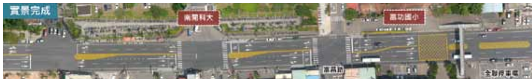
圖 5-3 台 14 線管線申挖路段進行全路幅路面刨鋪及標線改造成果（南開科大路段）
