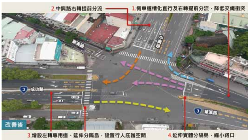
圖 5-7 改善後路口縮小，車向分流更明確，行車動線更安全
