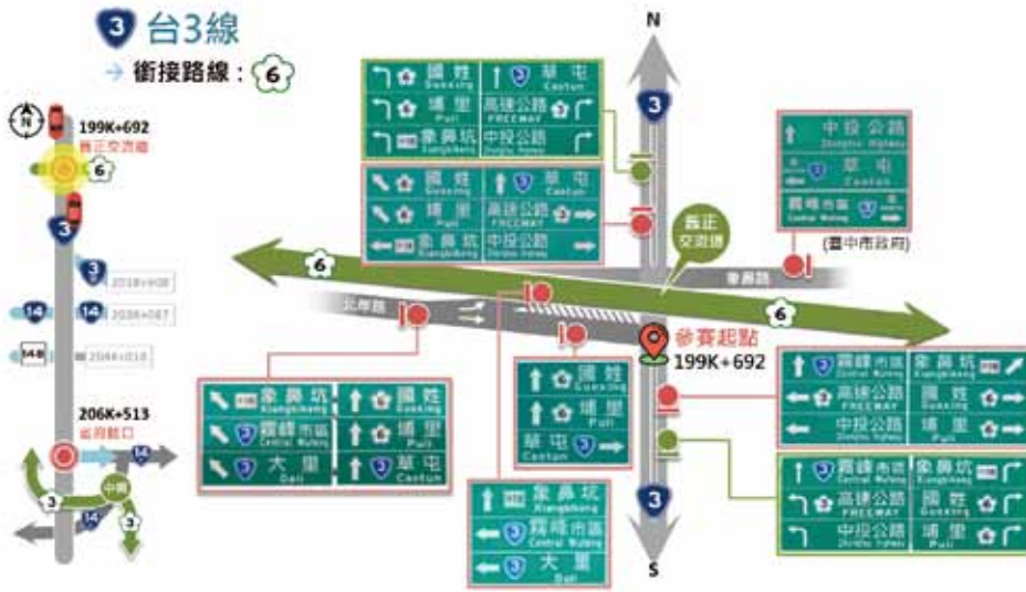
圖 3-2 台 3 線銜接國 6 舊正交流道路口決策資訊 (預告點、行動點、確認點)
