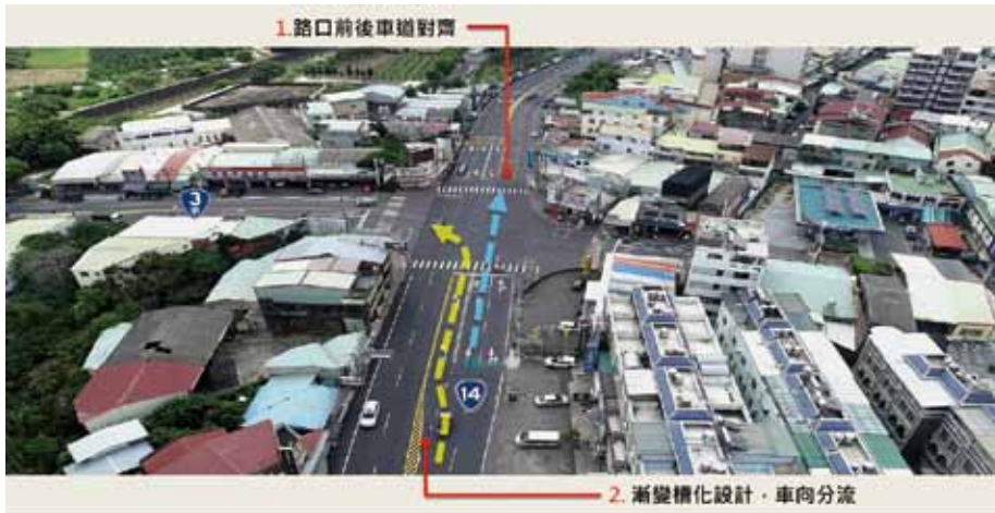
圖 3-10 台 14 線博愛路與台 3 甲線中正路口之標線資訊，偏心槽化導引左轉分流
