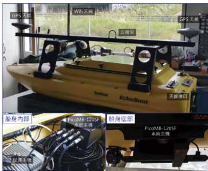
圖 3-3 PICO MB-120SF 多音束測深機系統架構
