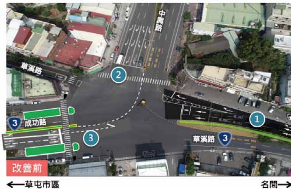
圖 5-6 台 3 線 / 中興路縮小路口範圍優化車道空間配置，提升路口人車安全環境
