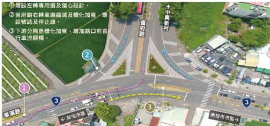
圖 6-4 台 3 線與省府路口，利用標線重新定義車道空間，使行車有序不搶道
