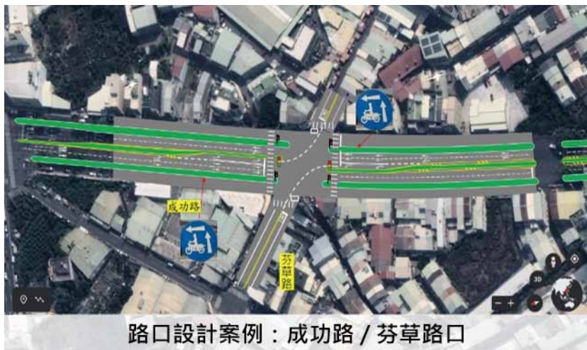
圖 5-9 南投段同仁自行規劃路口交通安全改善方案（外擴式左轉專用道）
