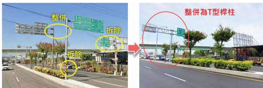
圖 3-1 標誌桿柱共桿與牌面整併減量
