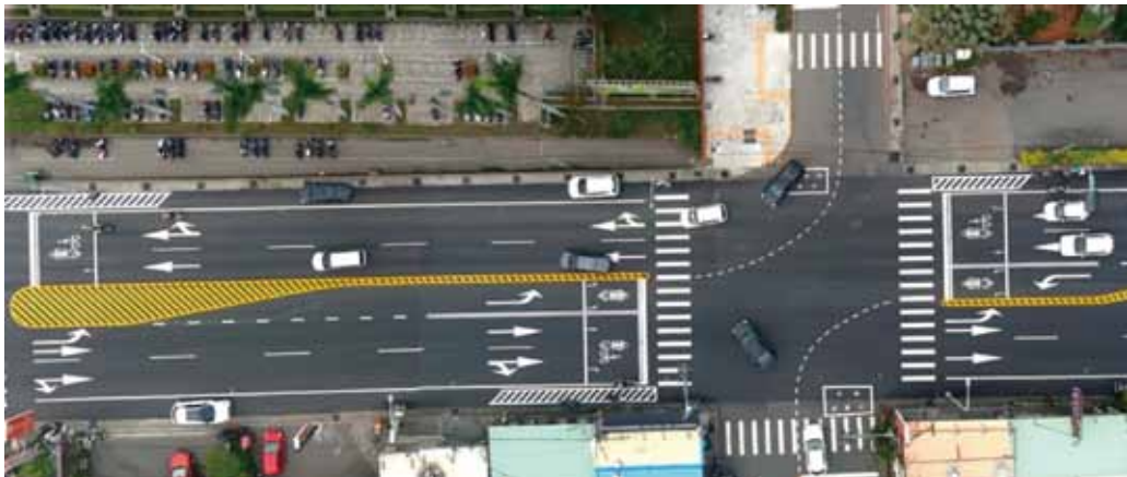
圖 8-4 左轉附加車道搭配左轉分流指向線，提前預告車道分流資訊 (一)
