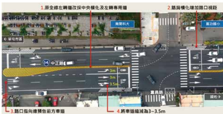
圖 3-11 台 14 線中正路與富昌路口之標線資訊，營造路口人車安全環境
