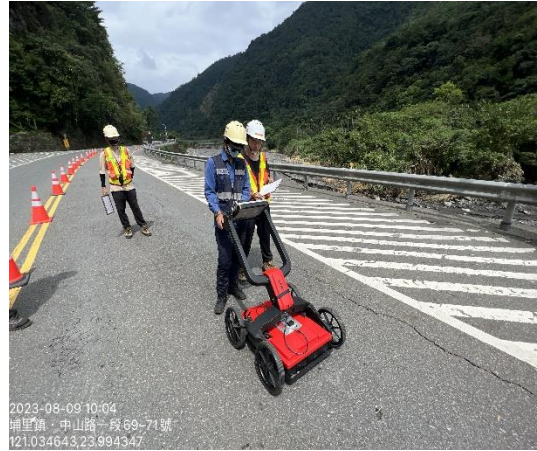
(2) 局長指示加速透地雷達作業速度及彙整檢測成果，以利掌握整體狀況
