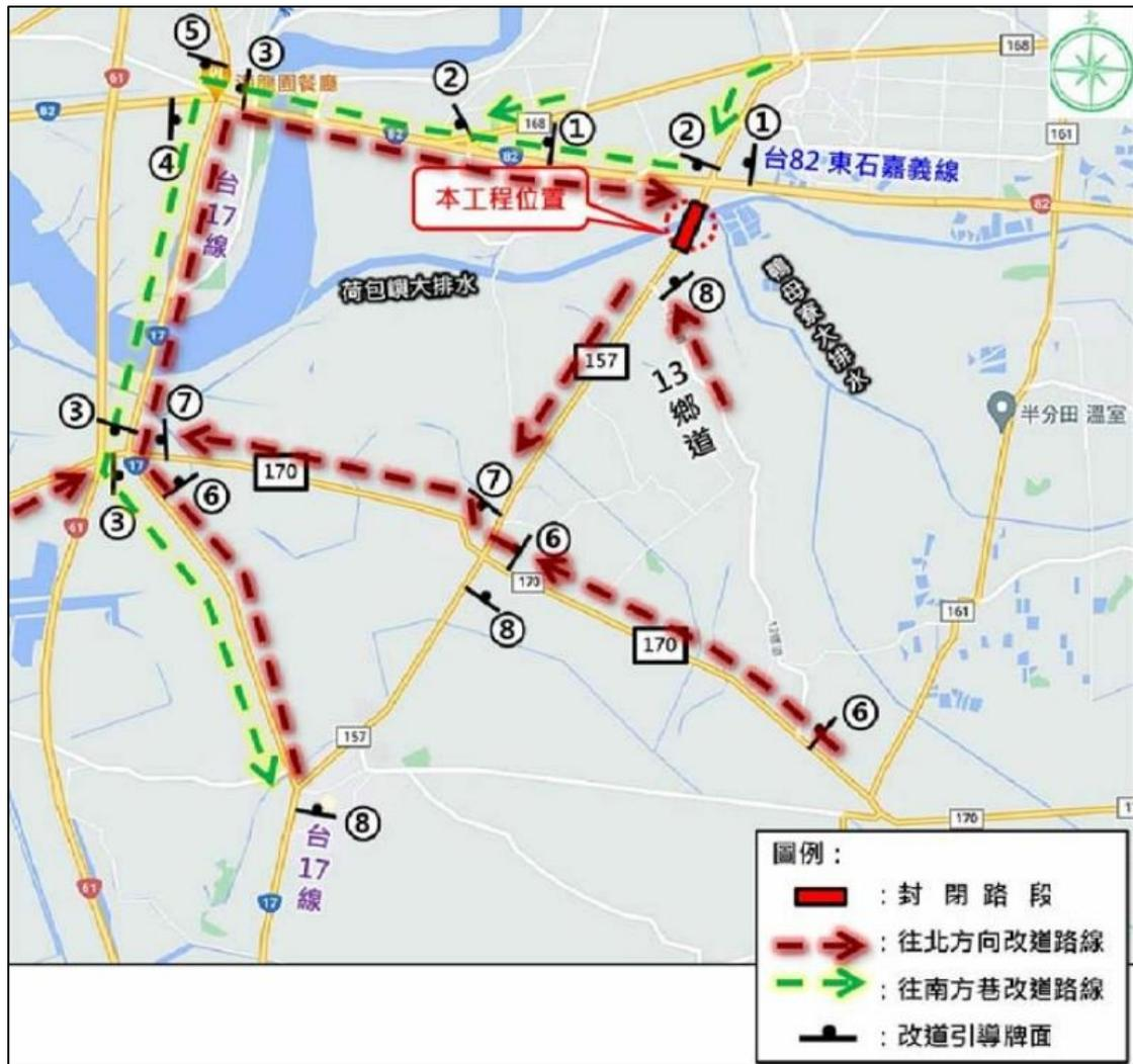
圖 3. 臥龍橋引道施作時所有車輛改道路線圖(第二階段)
